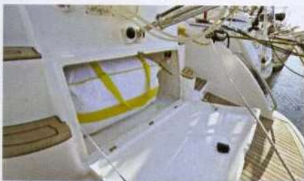
Sullo specchio di poppa un gavone serve per il ricovero della zattera di salvataggio.
