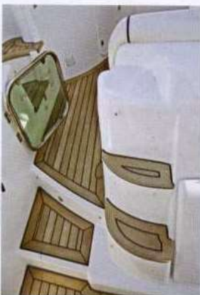
Sullo specchio di poppa un gavone serve per il ricovero della zattera di salvataggio.
